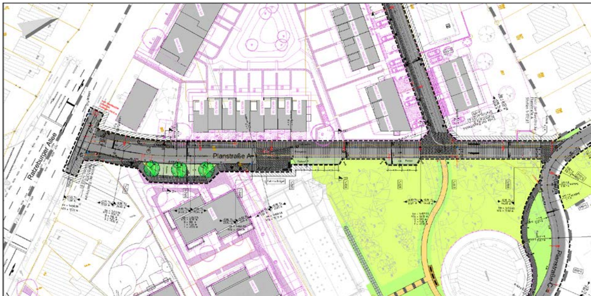
Ausschnitt Ausbaulageplan Verkehrsanlagen mit „Park am Wasserturm“ | pbh 2017
